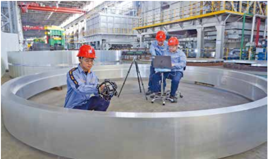
西南铝采用激光技术对铝合金环件尺寸精准测量
