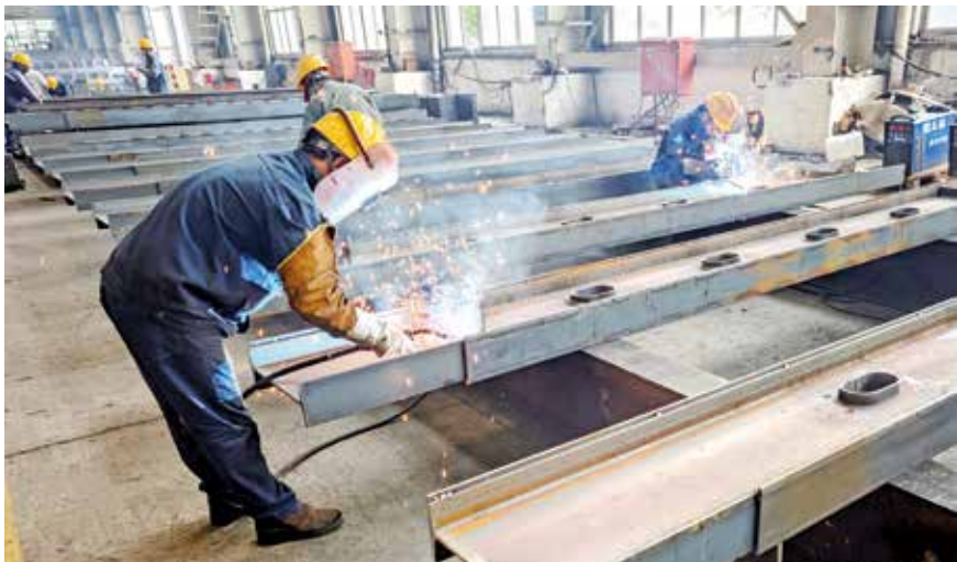
六冶焊工们正在紧张地进行电解槽结构焊接
