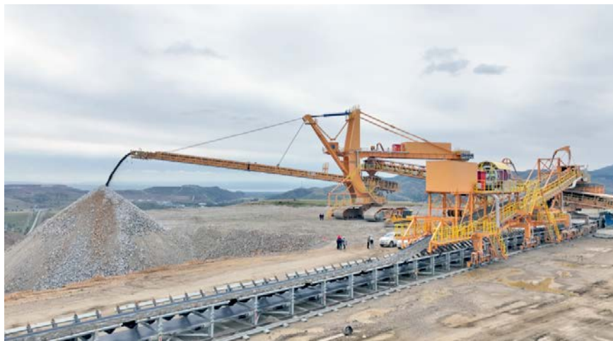
大苏计钼矿绿色节能减排废石胶带运输系统
