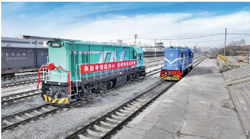
白银有色铁路运输物流有限责任公司上线纯电新能源机车，综合节能效率较传统内燃机车提升80%以上
